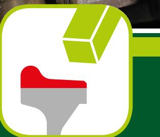
Tuhá maziva jsou s úspěchem používána na kolejových vozidlech, kde řeší problémy s opotřebením kol a spotřebou energií.
