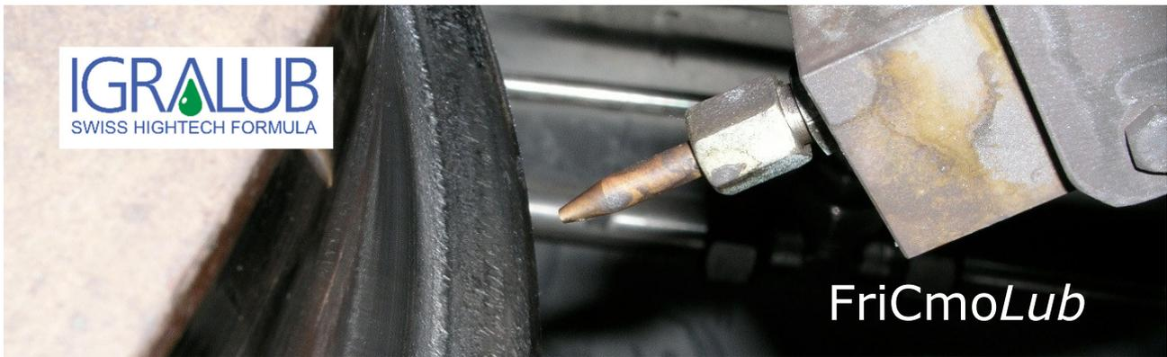
Hochleistungsfähiger, umweltfreundlicher Spurkransschmierstoff für fahrzeugseitige Sprühanlagen.
